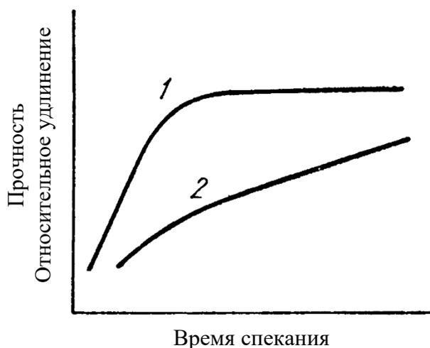
**Рис. 6** – Изменение прочности (1) и относительного удлинения (2) в зависимости от времени выдержки при изотермическом спекании
