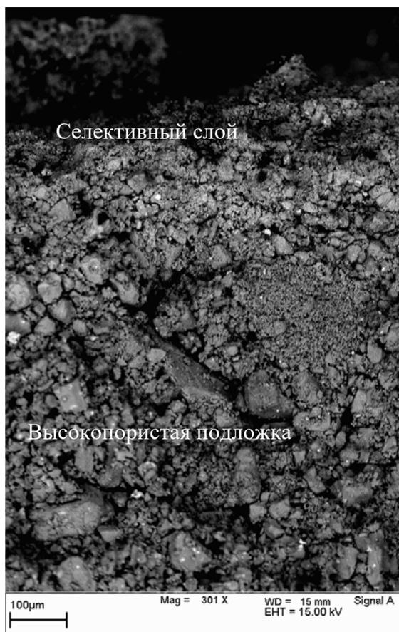
**Рис.35** – Микрофотография приповерхностной области образца
