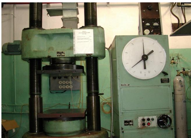
**Рис.13** – Гидравлический пресс П-250
