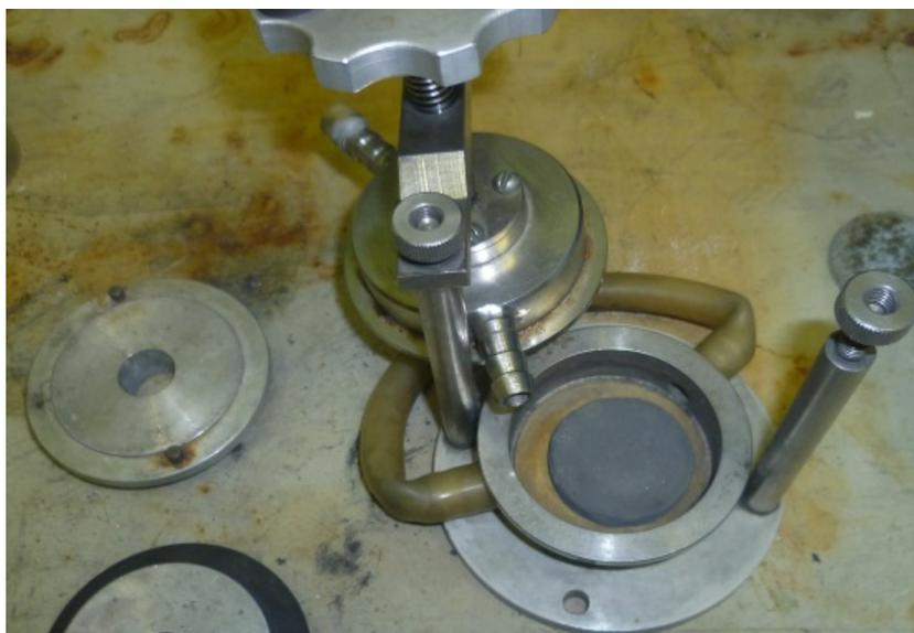
**Рис.34** – Внешний вид ячейки для определения размера пор методом пузырька
