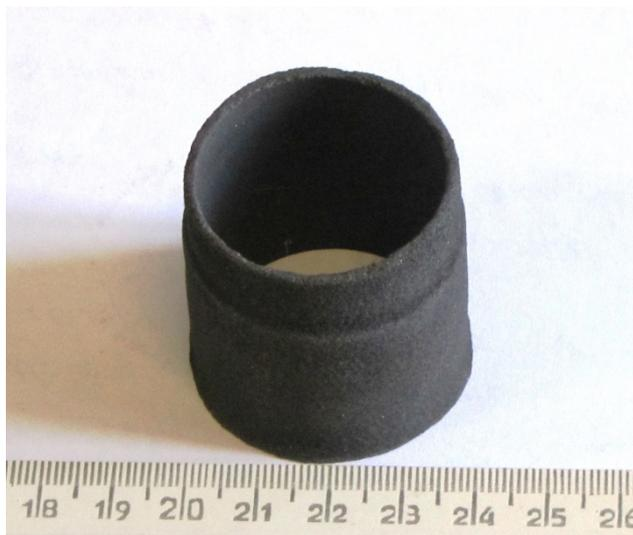
**Рис. 25** – Фотография полученной трубки из порошка карбида титана
